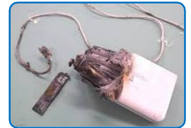
発火したモバイルバッテリー
