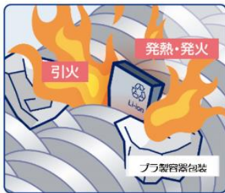
破碎機にLiBが巻き込まれ 発火するイメージ
