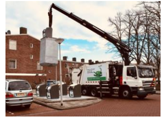
地下コンテナを引き上げる ゴミ収集車
